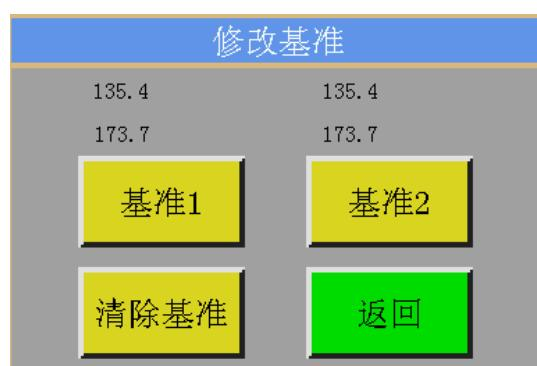
修改基准：将当前选中的针点设置为图形的基准点，“基准 1”设为基准点 1，“基准 2”设为基准点 2，“清除基准”清除已经设置的所有基准点。
