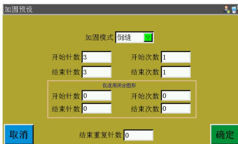
**加固模式**  **倒缝** ：加固模式选择有三种加固模式，为倒缝、缩缝和人字缝。
