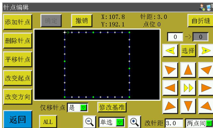
可以选择某个针点进行添加针点、删除针点、平移针点、改变针点等操作。添加针点、平移针点：选择该功能，然后通过 选择某个点，选中的针点变为红色，通过方向键移动光标到需要添加针点或者平移针点的位置，再点击“确定”键即可完成相应的操作。（注：**添加针点**、**平移针点**按钮为棕色背景时表示功能开启状态，可持续进行添加针点或平移针点操作，再次点击恢复至黄色背景可关闭该功能）
