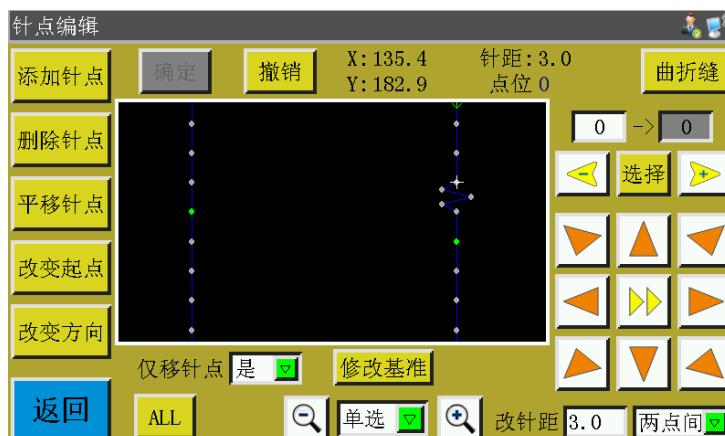
**节点编辑**：整个图形以很多节点的方式呈现可以通过添加、删除、平移节点来改变曲线。甚至可以改变起点和整个图形的方向（各按键操作模式和针点编辑的一样）。界面图如下：
