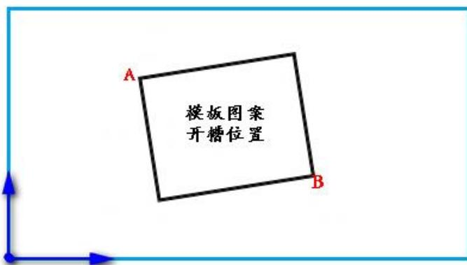
故需将基准点 1 与 A 对位，基准点 2 与 B 对位，调整系统中加工图案位置与模板开槽位置对应。
