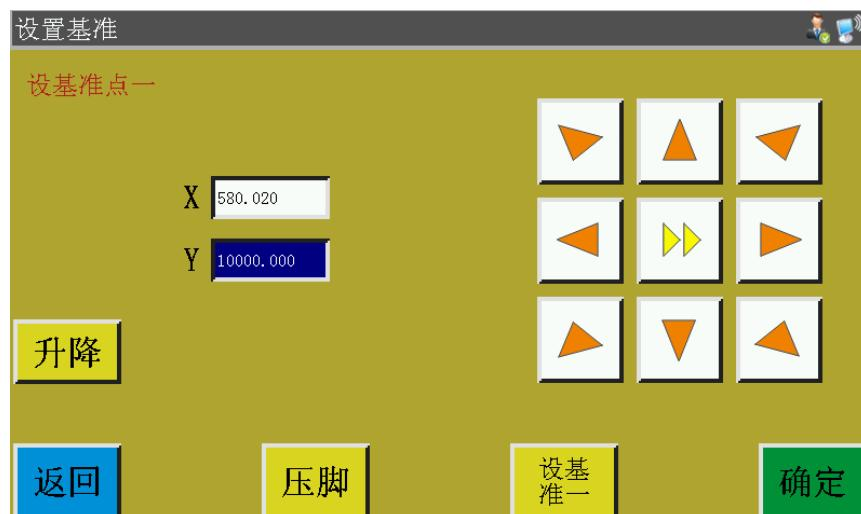
**升降**: 升降功能主要是用于“旋转机头”类型机器，对应设定的参数（P249）输出 IO，高低电平互相切换。
