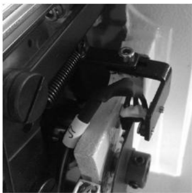
图（5正面）断针保护传感器安装后
