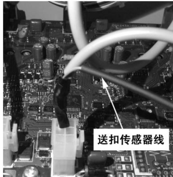
图（3）送扣传感器安装后（438D、438FX）
