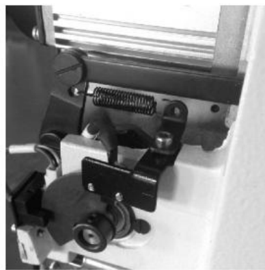
图（6侧面）断针保护传感器安装后
