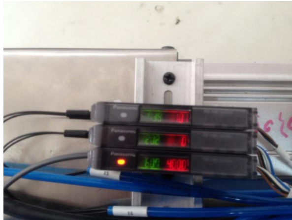
起缝光纤传感器X5 结缝光纤传感器X6 断线光纤传感器X9
